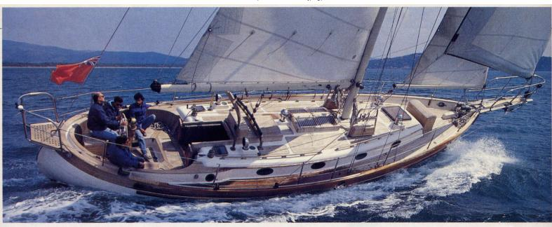
Durante la prova, che si è svolta con 14 nodi di vento reale, l'Hans Christian 43 ha mostrato un ottimo passo e un'eccellente stabilità di rotta, frutto della configurazione a chiglia lunga. Per migliorare l'angolo di bolina è necessario installare un tendipaterazzo, così da ridurre la vistosa catenaria dello strallo di prua. L'armo a cutter provvisto di trinchetta bomata e yankee avvolgibile, oltre a facilitare le virate, permette di ridurre la superficie rollando la vela anteriore.
